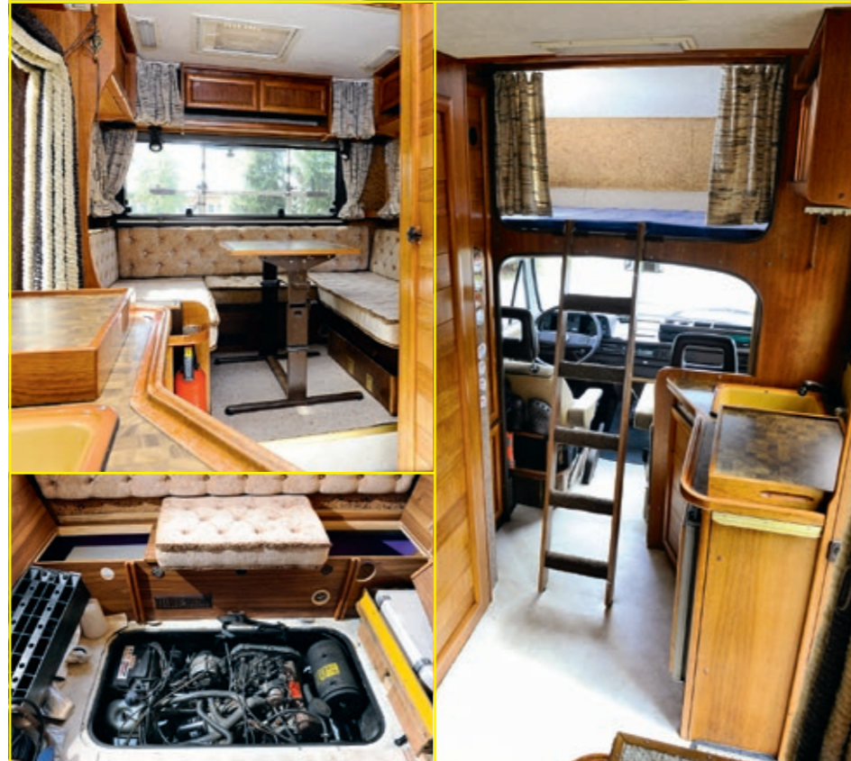
WOHLNICH und weitläufig. Die plüschige Sitzgruppe im Heck lässt sich bei Bedarf zum Doppelbett umbauen. Wer an den Turbodiesel darunter möchte, muss die gute Stube in großen Teilen demontieren. Rechts steht der Küchenblock, links geht es zu Nasszelle und Toilette, eine Leiter führt zum Alkoven
